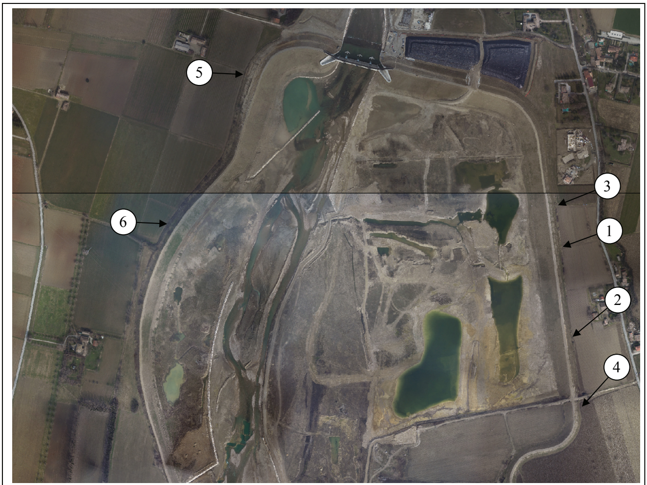
Figura 3-2 - Posizione delle principali venute d'acqua riscontrate durante l'esecuzione degli invasi sperimentali.
