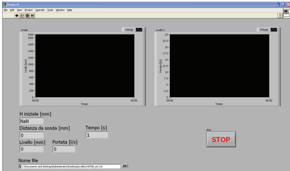
Figura 2-3 Software di acquisizione del livello e calcolo della portata drenata
